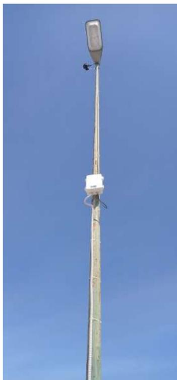
**TRAFICAM AI** grazie alla facilità di installazione e configurazione, alla capacità di memorizzazione locale dei dati ed alla sua possibilità di collegamento wireless WiFi, trova un largo impiego anche nell'ambito di campagne temporanee di misura del traffico.
