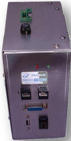
**FALCON** è una soluzione compatta di **lettura delle targhe** che integra la logica di controllo per la gestione degli **accessi carrabili**. Alloggiato in un compatto contenitore da barra DIN il sistema permette di **interfacciare** le principali **telecamere IP** presenti sul mercato e tutte quelle conformi allo standard **ONVIF**. Il sistema può gestire dei lettori Rfid per l'integrazione di accessi pedonali all'area.
