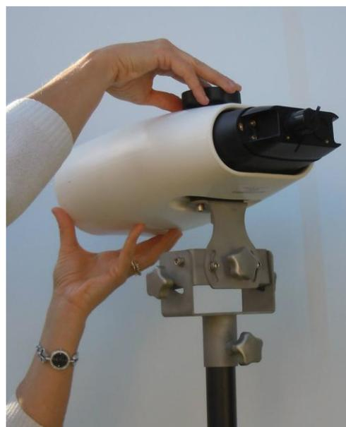
**INSERTO CONICO PER IL SUPPORTO DEL LETTORE E VOLANTINO DI FISSAGGIO**
